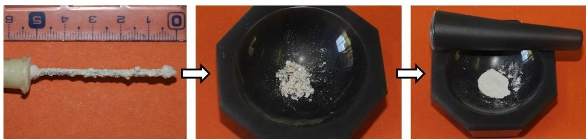
Figure II-14 : photographies des différentes étapes du broyage
